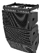
Das GEO M1210 ist ein passives oder aktives 2-Weg-Line-Array-Element mit 12" 8243;-Basschassis mit 3" 8243;-Schwingspule / 1,4" 8243;-Mittel-/Hochtontreibern. Mit den Maßen 700 x 370 x 446 mm (B x H x T) und einem Gewicht von 34 kg stellt das Modul GEO M1210 die Touringversion des GEO M12 mit 10° vertikaler Abstrahlung dar. Die Gehäuse lassen sich auf 80° oder 120° horizontale Abstrahlung umstellen, indem ohne erforderliches Werkzeug magnetische Anbauteile vor den Waveguides befestigt werden
