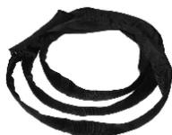
RSE-SRS Rundschlinge mit Stahlseileinlage in Anlehnung an EN 1492-2 und EN 13414-2 Sicherheitsfaktor 52 m Umfang thomann 1 m Nutzlänge Tragfähigkeit 2000 kg kleinster Kantenradius 6 mm schwarzer Polyester-Außenmantel vielseitige Einsatzmöglichkeiten im Bereich der Bühnentechnik Kontrollfenster zur Überprüfung der Seileinlage durch die Stahlseileinlage entfällt die Anforderung der BGV-C1 nach einer Sekundärsicherung
